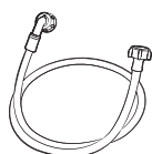
Шланг подачи холодной воды
